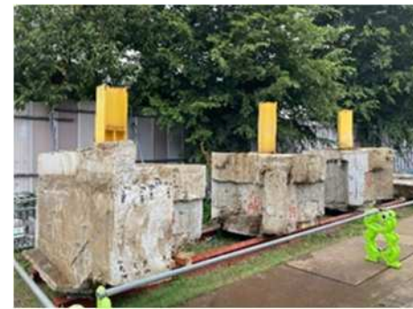
図 10. リユース RC 部材の保管
