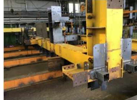
図 9. リユース鉄骨部材の加工
