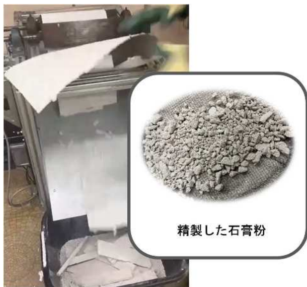
図6 石膏粉の精製と安全性検証
