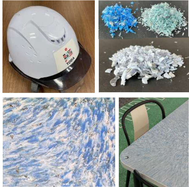
写真5. (左上) ヘルメット (右上) 粉碎したペレット (左下) 熱圧縮したパネル (右下) テーブル天板に転身 ○エスエス
