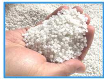
養生材から製造した再生樹脂
