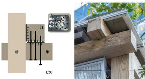
図6 軸組をずらして留めた接合方式
