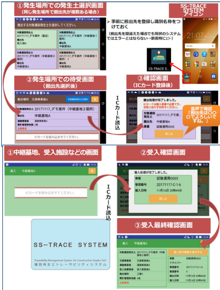
図2 SS-TRACE SYSTEMのスマートフォン画面例
