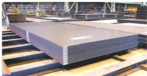
写真 4-C 熱延鋼板 (カットシート)
