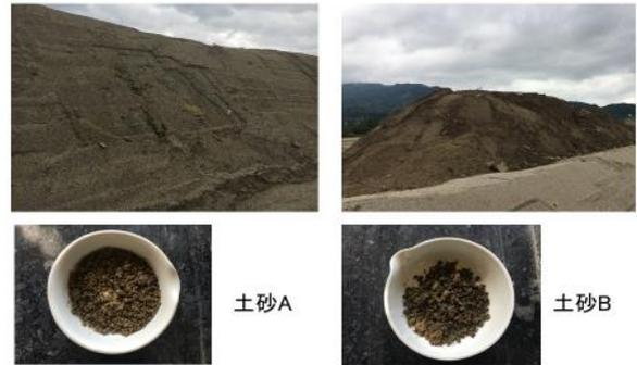
入が見られました。この仮置き場では、その他に処分する場所がないことから、悪い状態の土砂を良い土砂の上に載せてしまっており、このままの状態だと瓦礫が混ざってしまう状態でした。それでも、高度選別処理を施せば十分に有効に使えると思います。
