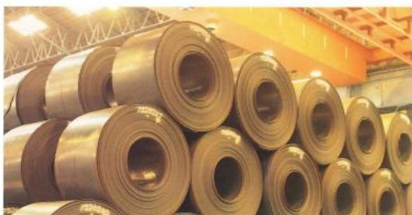
写真4-A 熱延広幅帯鋼 (ホットコイル)
