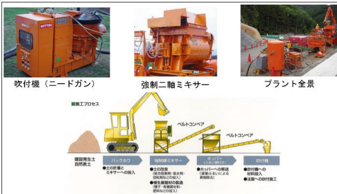
図-2 施工システム
