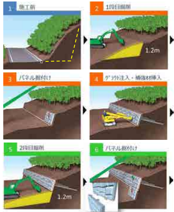
図-3 標準勾配 1 : 0.3 の施工手順
