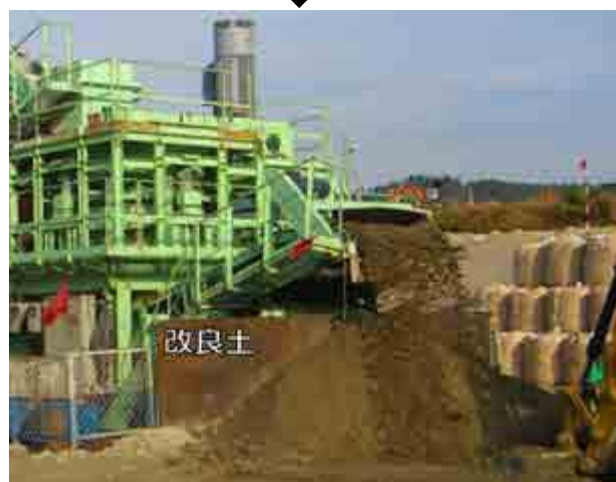
写真-2 軟岩破碎混合の事例
