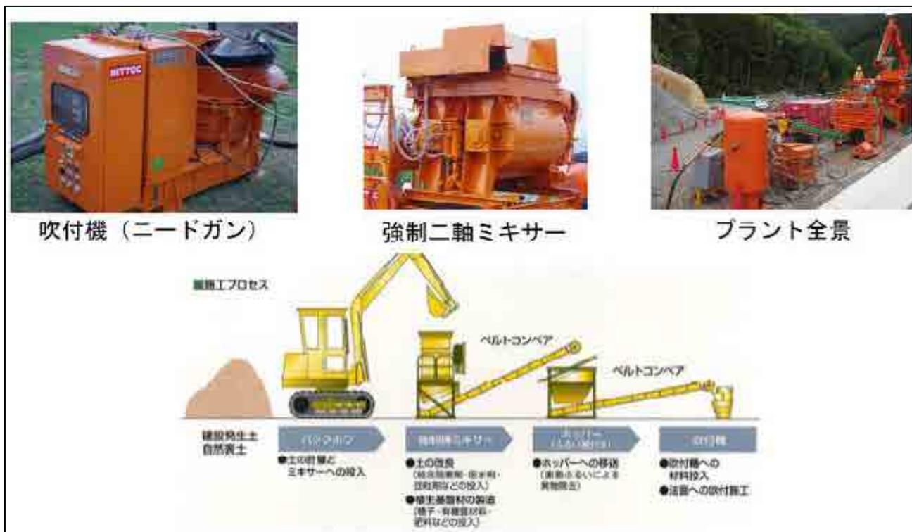
図-2 施工システム
