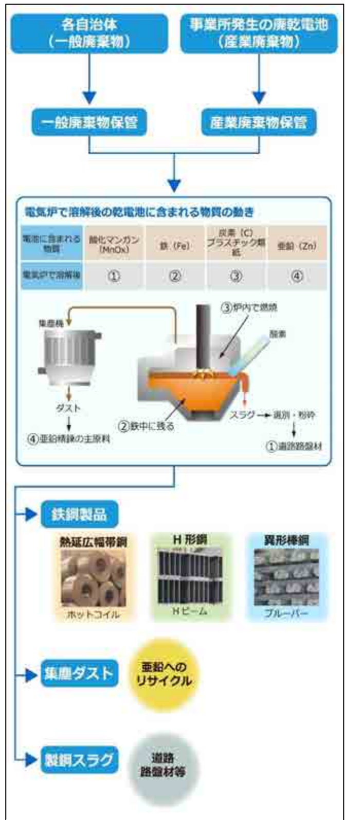
図3 東京製鐵(株)岡山工場の乾電池リサイクル工程
