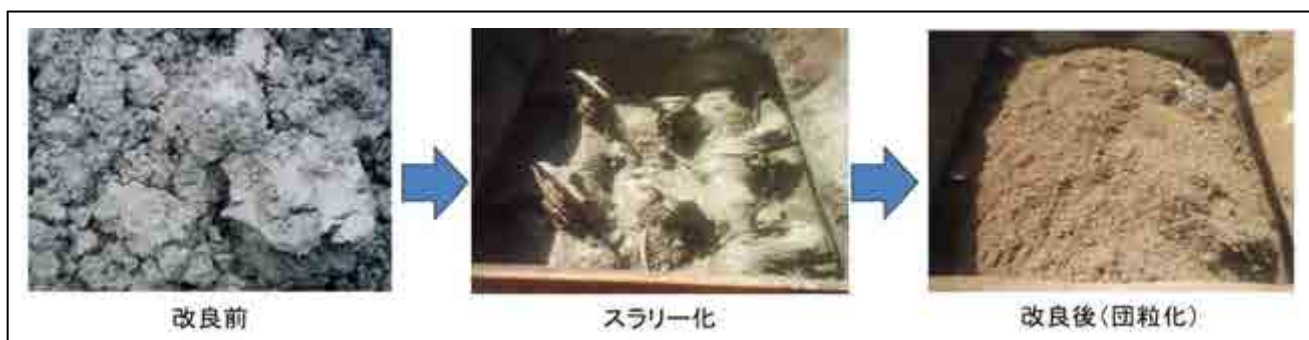
図-1 カエルドグリーン工法による土の改良
