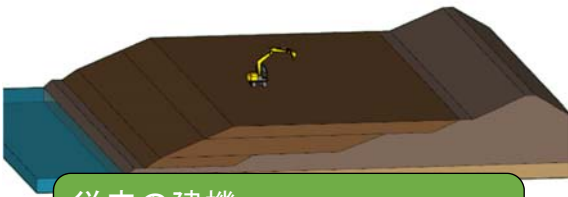
①従来のバックホウで施工
