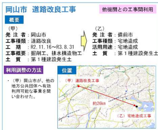
図-3: 他機関との工事間利用例
