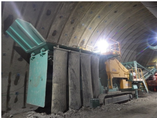
写真-1 移動式破砕機（左）と破砕状況（右）
