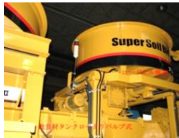
改良材タンク(ロードセル付)
