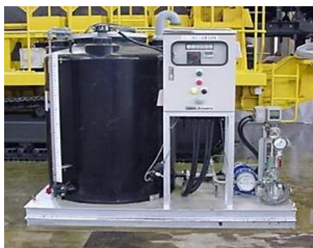
不溶化処理用薬液ユニット
