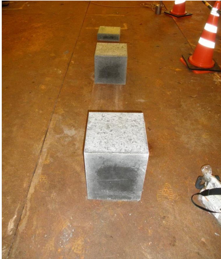
脱型後の供試体
