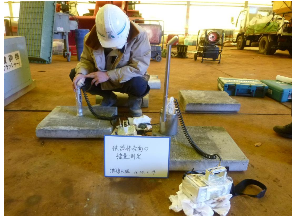
側溝蓋の放射線測定
