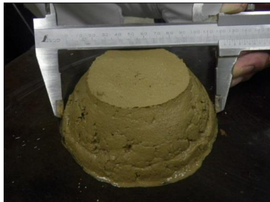
ボンテラン工法による改良直後の状況
